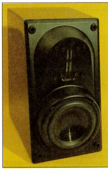
Le Modulus sono un due vie dotate di un woofer IMG di 14 cm di diametro e di un tweeter EMIT K, che conferisce al suono del diffusore il tipico carattere Infinity. componenti sono montati su piani differenti per allinearli temporalmente.
